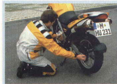
2-14. ábra. A lengőkar csapágyazásának ellenőrzése
