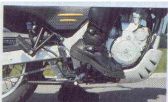
2-28. ábra. A hidraulikus fék ellenőrzése a motorkerékpár álló helyzetében
